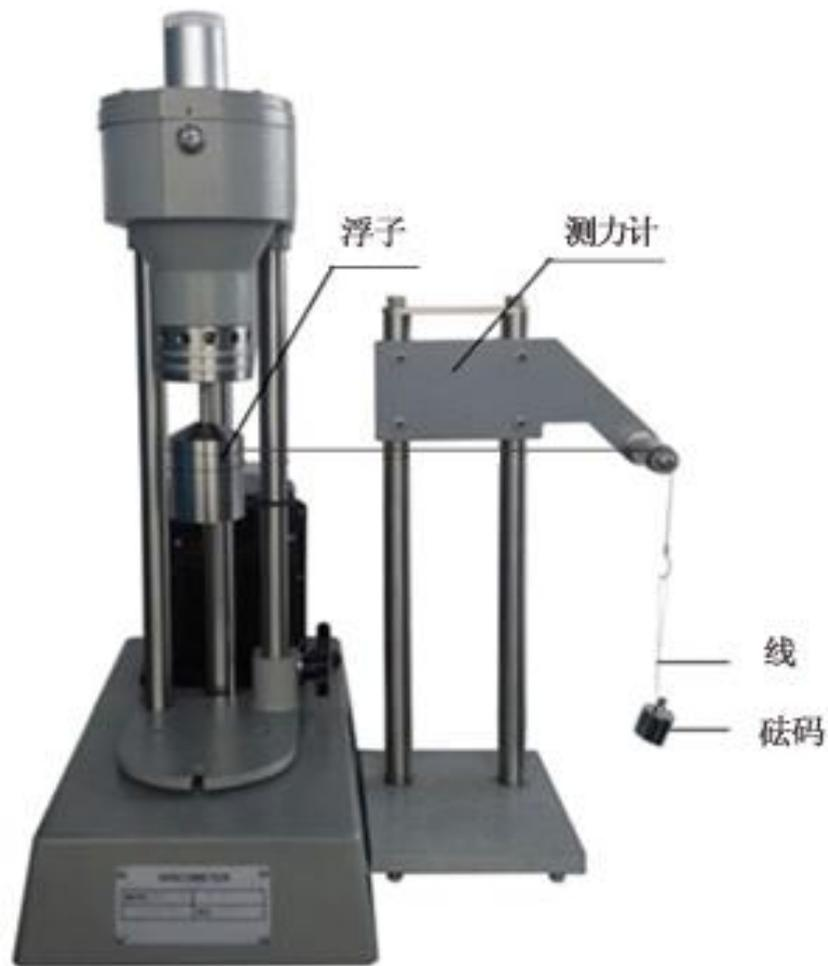
图 6-1 型号 1105 扭簧测力架校准装置
