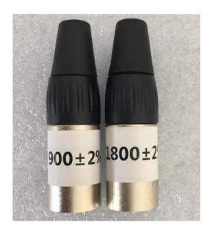
注意: 青岛创梦仪器有限公司为电压制定了校准标准和校准测试,每种校准标准都有唯一的电压读数。
